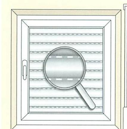
An sonnigen und heißen Tagen sollten Sie beachten, dass die Licht und Lüftungsschütze geöffnet bleiben! Sie sorgen so für eine ausreichende Hinterlüftung Ihres Rollladens und vermeiden einen Hitzestau, der dazu führen könnte, dass der Rollladen ausbaucht.
