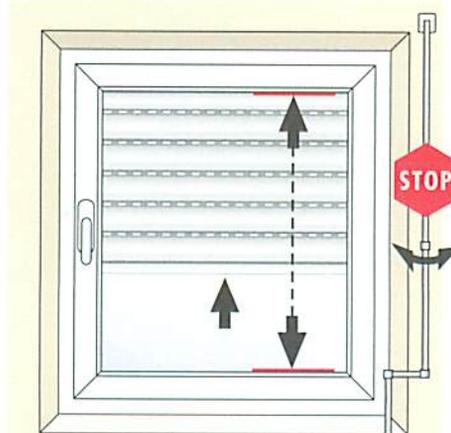
Achten Sie auf die korrekte Drehrichtung der Kurbel! Kurbeln Sie nicht weiter, wenn Ihr Rollladen ganz geöffnet bzw. geschlossen ist. Bei Kurbelantrieb Kurbeln am Gelenk nicht zu stark ablenken, max. 30°.
