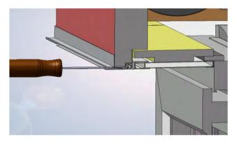
Schieben Sie das Werkzeug an der Unterseite des Kastens bis zum Anschlag zwischen Kunststoffleiste und Aluprofil.
