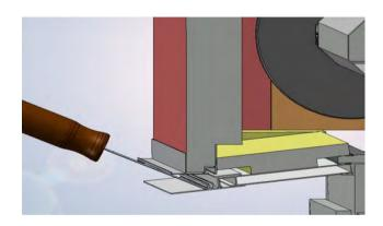
Hebeln Sie das Werkzeug nach oben, sodass die Kunststoffleiste nach unten herausspringt.
